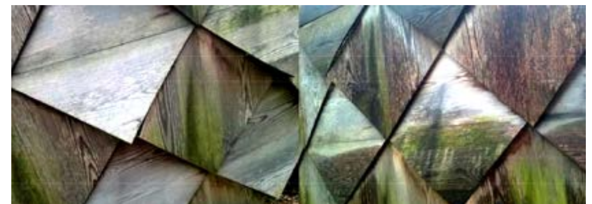
Obrázek 2: Prototyp Ray2, klimaticky responsivní stěna větrající za sucha a uzavírající se za vlhka skrze borcení, která je osídlená řasami, které modifikují její performanci skrze odsávání vlhkosti ze dřeva. Všimněte si také distribuce osídlení řas podle nejvlhčích částí formální stránky prototypu. Vzniká tak interakce mezi performancí formy, živým osídlením a mikroklimatem. (foto: Davidová 2017)
